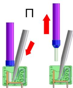
1. Introducir el destornillador sin ejercer fuerza lateral en la abertura angular para abrir la línea de contacto.
