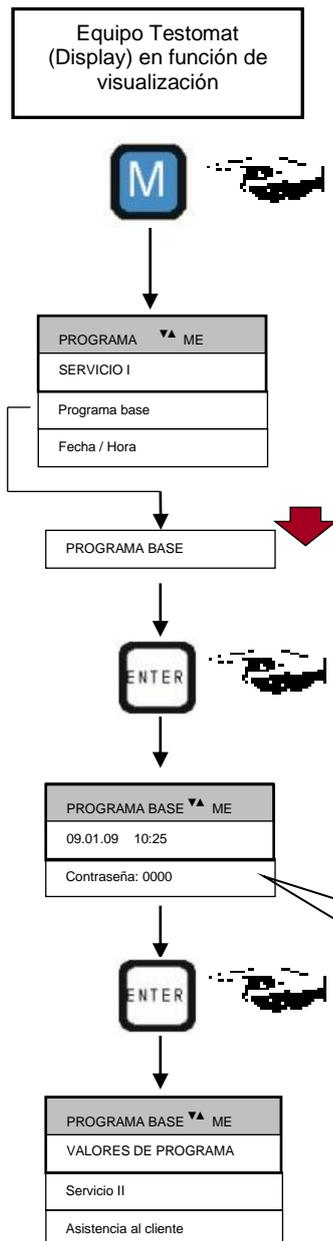
Para introducir datos y ajustes al programa básico se requiere una contraseña de cuatro dígitos. La contraseña consta de la secuencia inversa de las cuatro cifras horarios del equipo Testomat 2000®.
